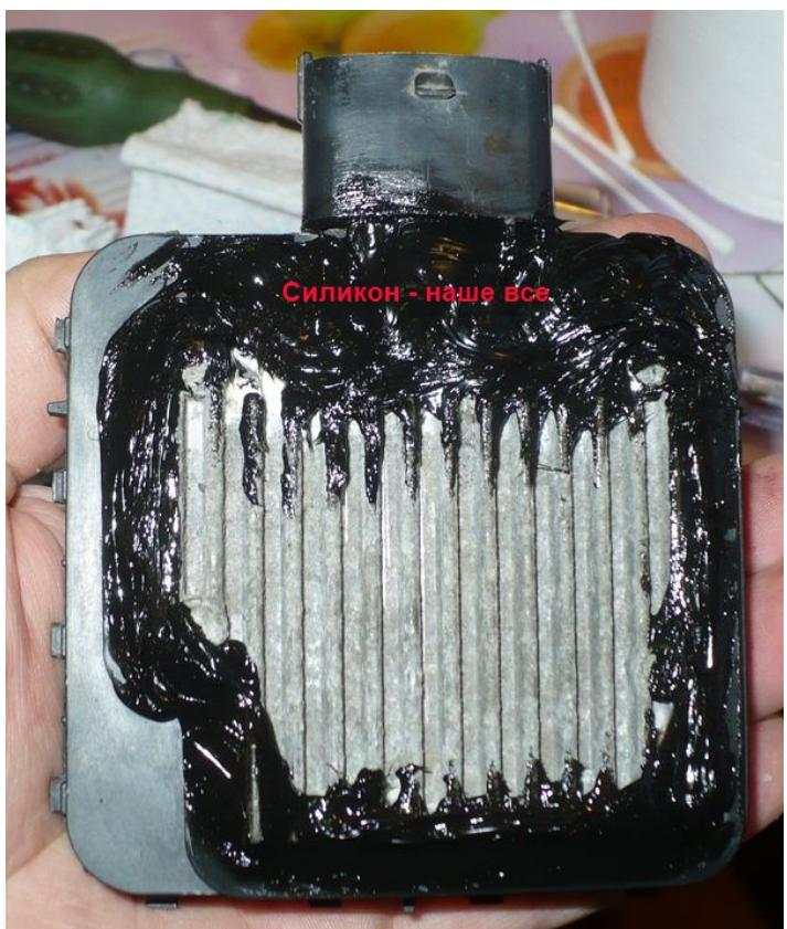
Обратную сторону платы защитил слоем резины. Тоже у микросхемы. Коробку с радиатором пролил лаком. Промазал по периметру герметиком.
