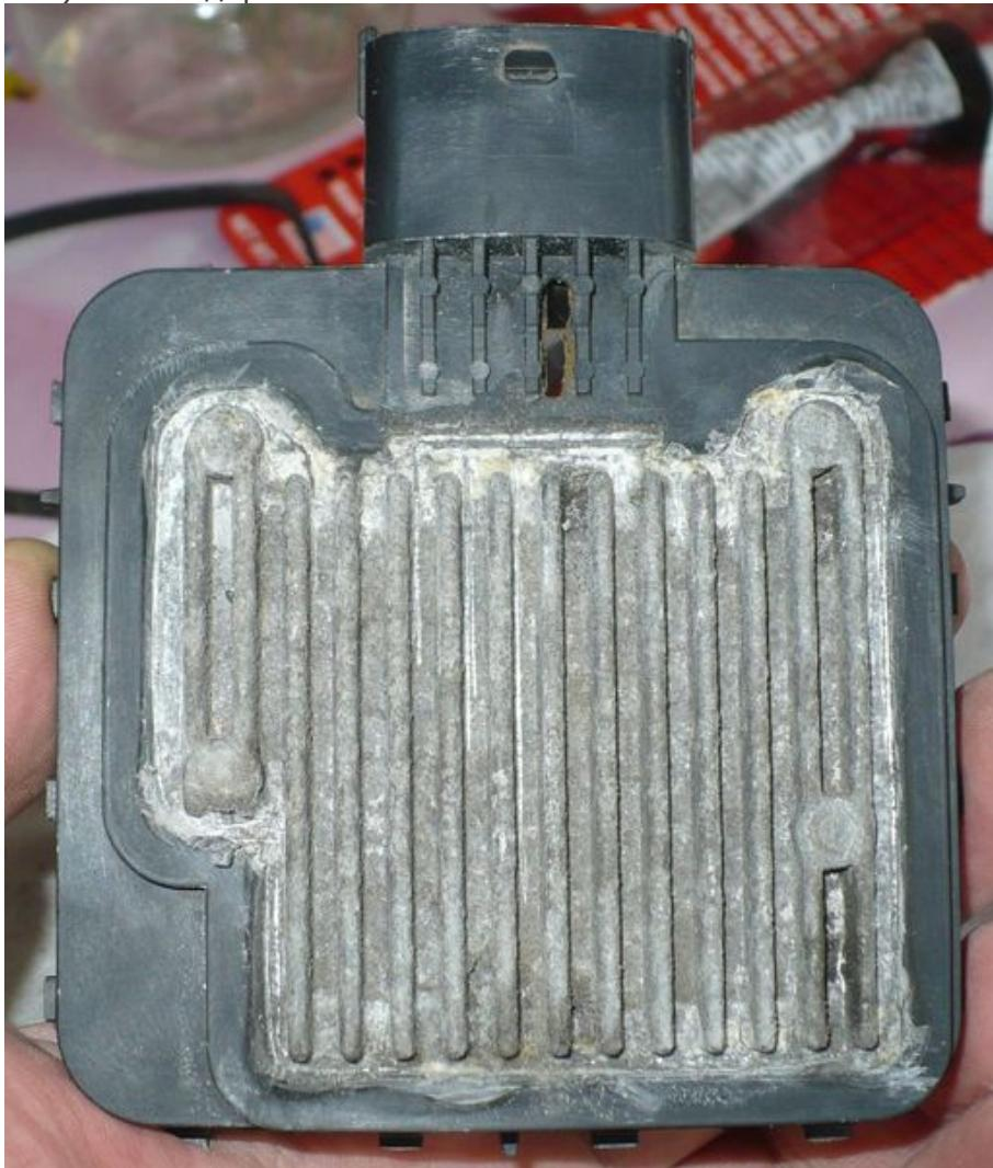
Потом отрезал старый герметик вокруг радиатора. Пошкрябал отверткой - остатки окислов удалить. Решил спаять обратно на проводах чтобы если что не мучаться и не выпаивать заново.
