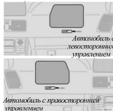
Расположение подушки безопасности на стороне пассажира
