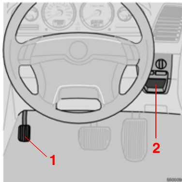
Стояночный тормоз в автомобиле с правосторонним управлением
