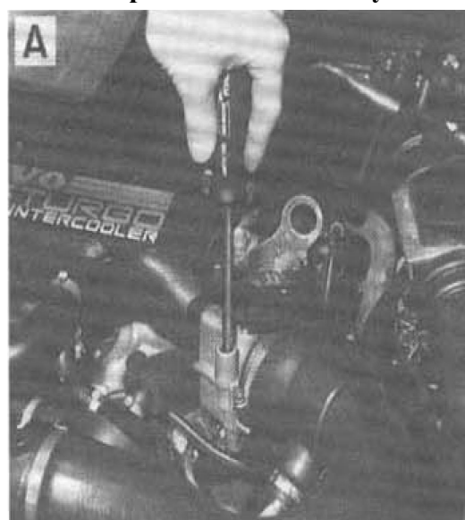
Винты регулировки холостого хода: А - регулировочный винт подачи воздуха
