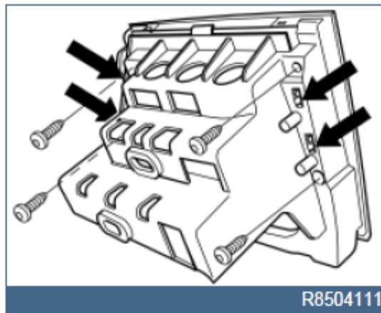
5. Ссади радио, держится на четырех саморезах, не отключая провода их можно выкрутить трещеткой с насаженной битой или короткой отверткой, если будет мешать рычак КПП, его можно передвинуть опять вставив ключ. Опять же аккуратнее с проводами что бы не отсоединились.
