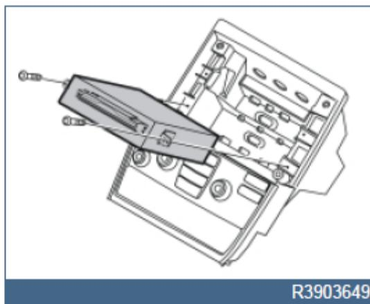
6. Отведя радио вверх, не отцепляя проводов, откручиваем привод диска, он держится на двух саморезах. Отсоединяем провод, только осторожнее пальцами грязными туда не тыкайте, т.к. звук идет через оптоволокно.
