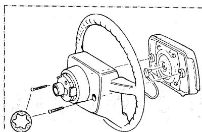
**ВНИМАНИЕ:** При снятой надувной подушке безопасности не поворачивайте замок зажигания в положение ON, иначе это может привести к записи кода неисправности.
