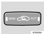
этом осуществляется автоматическое управление рециркуляцией. Для предотвращения проникновения в салон выхлопных газов или загрязненного воздуха можно включить рециркуляцию вручную. При включении этого режима осуществляется рециркуляция воздуха в салоне и система управления микроклиматом не забирает воздух извне. Светится светодиод в выключателе. При рециркуляции воздуха в салоне повышается риск запотевания или обледенения стекол, особенно зимой.
